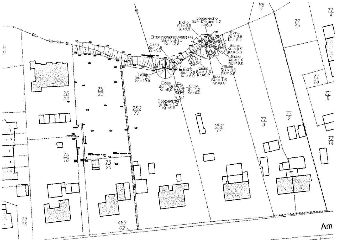
Abbildung: Katasterplan mit punktuellen Vermessungsergebnissen
