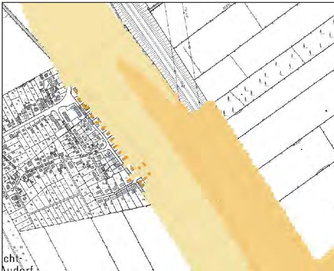
Abbildung 27: Belastete Gebäude in Schacht-Audorf > L<sub>Night</sub> = 55 dB(A) (orange)
