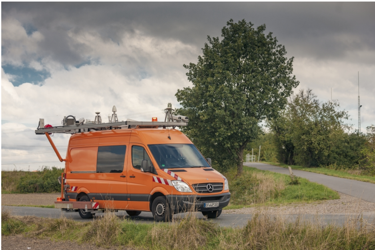
Messfahrzeug für Messung Ebenheit und Substanzmerkmale
